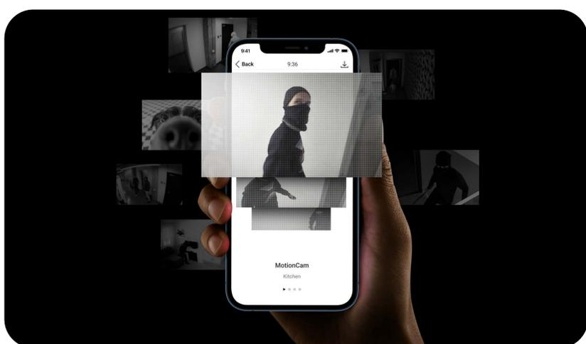
Der Melder ist mit einer eingebauten Kamera ausgestattet und sendet animierte Fotos an den Sicherheitsdienst und die Benutzer. Das Gerät vier Arten der Fotoverifizierung: Nach Alarm, Nach Szenario, Nach Zeitplan und Auf Anfrage. Die Fotoverifizierung ermöglicht es, die Situation im geschützten Objekt einzuschätzen, zu prüfen, ob der Alarm echt ist, und entsprechend zu reagieren.
